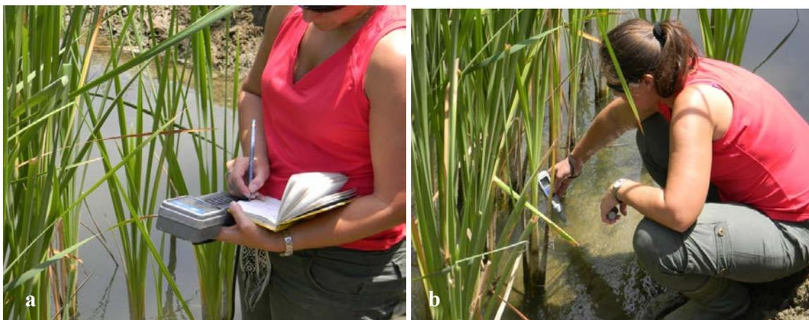
Figura 6. Medición de parámetros fisicoquímicos usando el equipo multiparamétrico (a) y el pHmetro (b).
