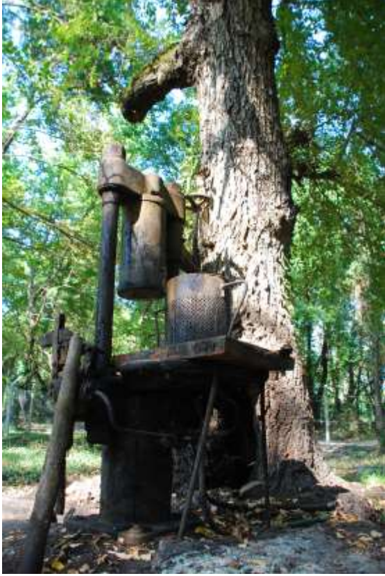
Fotoğraf: Okan Ürker- Sığla yağının elde edildiği mekanik bir sıkma-pres makinesi, yerel adıyla ‘Günlük Düveni’
