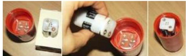
Figuras 3. Instalación de baterías en los pingers.
